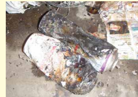
火災の原因となったカセットボンベ
